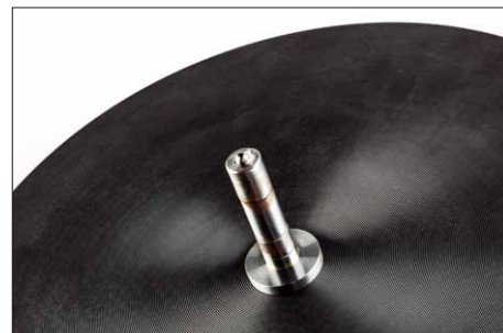
Die gehärtete Edelstahllachse hat eine eingepresste Lagerkugel und eine Verjüngung für das Ölreservoir
