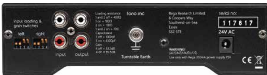
Die elektronische Anpassung des Fono MC an das jeweils verwendete Tonabnehmersystem erfolgt über zwei Bänke von jeweils vier Dip-Switches auf der Rückseite des Gerätes
